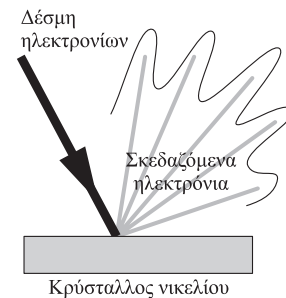
Σχ. 13.9: Το πείραμα των Davisson-Germer. Η σκέδαση μιας δέσμης ηλεκτρονίων από έναν κρύσταλλο νικελίου παρουσιάζει μια κατανομή εντάσεων χαρακτηριστική ενός πειράματος περίθλασης, στο οποίο κύματα συμβάλλουν ενισχυτικά ή αναιρετικά σε διαφορετικές διευθύνσεις.
